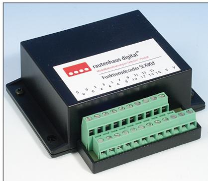
Weichenantrieben und Beleuchtungen, sie erfolgt getrennt vom SX-Bus. Der eingesetzte Transformator muss die erforderliche Spannung und Leistung (angegeben in VA) sicherstellen.
